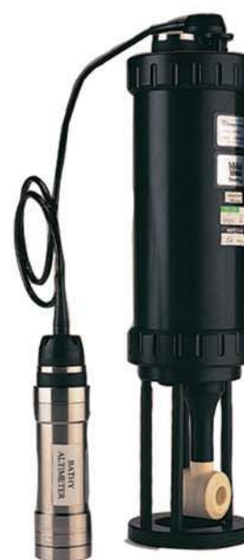
Conjunto oceanográfico con sonda de Conectividad-Temperatura
