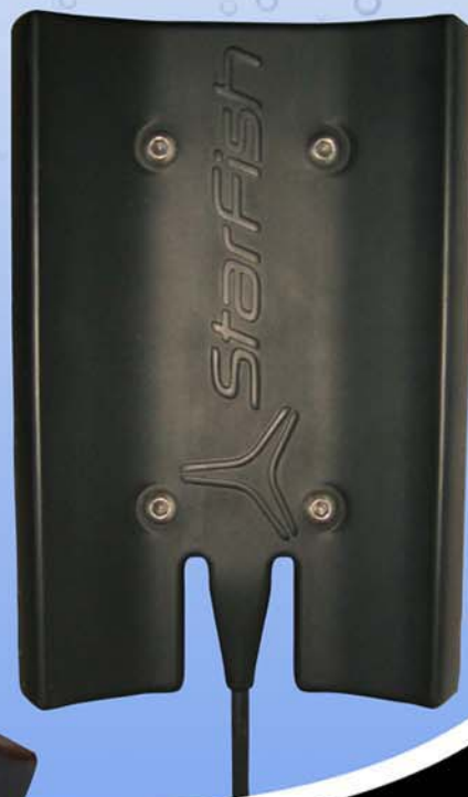
Transductor StarFish 450H (dcha) y soporte de fijación al casco (izq).
