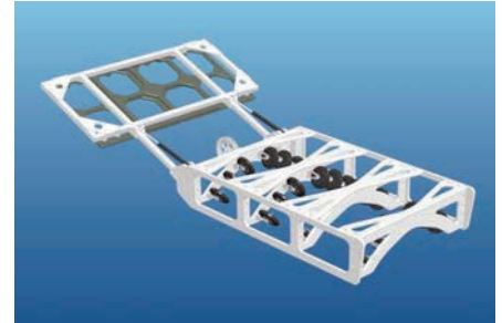
Ejemplo de skid de herramientas específicas: skid con ruedas para el seguimiento de conductos submarinos
